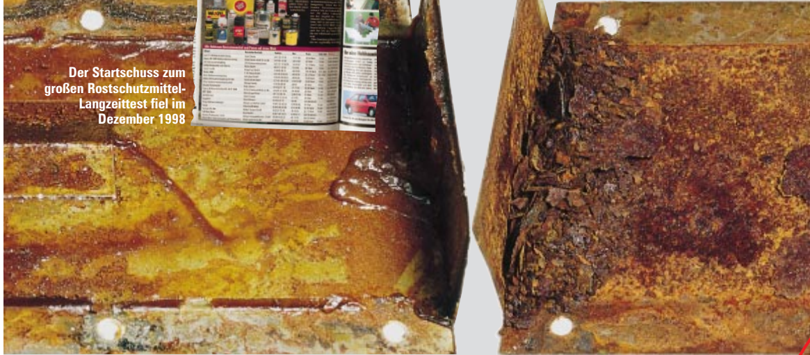
Links: Sanders Fett ließ der Korrosion kaum eine Chance. Der rechte Kasten, mit Rostschutzöl von Owatrol gefüllt, ist fast zerbröselt
